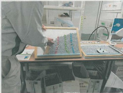
土圧の模型 (ナットで作成)
